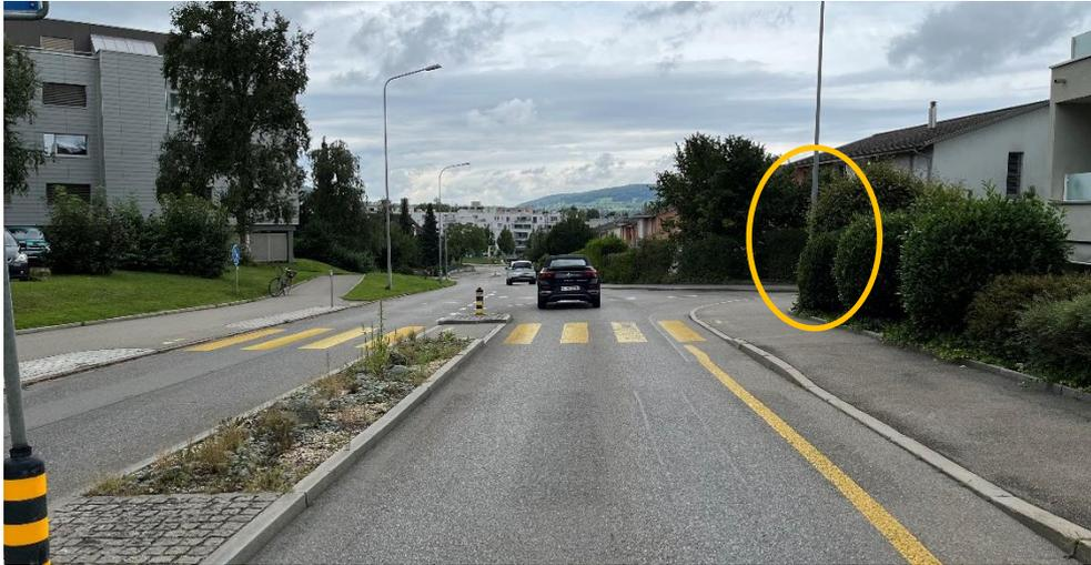
Ausserdem bewirken die allseits an den Knoten vorgesehenen vertikalen Versätze mit Schachtbrettmarkierung, dass auch von den seitlichen Einmündungen mit reduzierter Geschwindigkeit auf die Hofstetterstrasse eingefahren wird.
